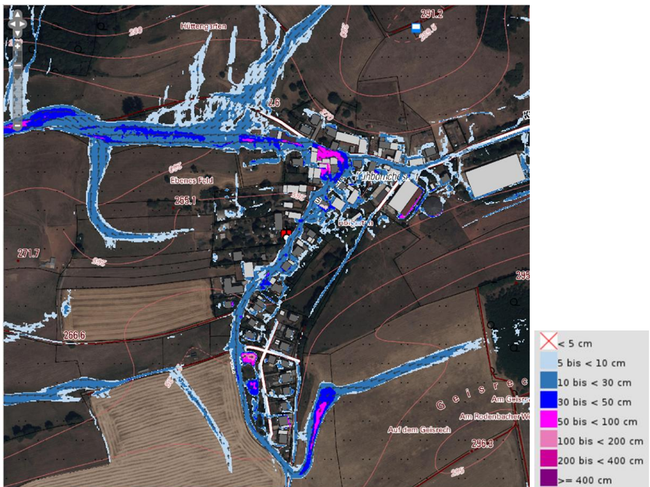
Abb. 103: Überflutungsgefährdung des Kühbörncheshofes, Sturzflutgefahrenkarte [1] für SRI 7, 1 Std.
